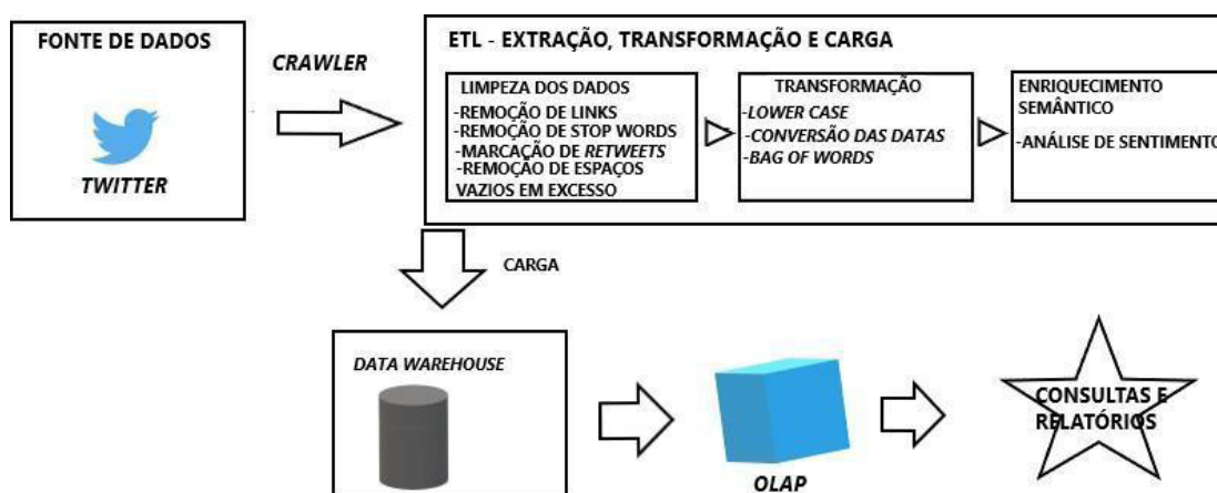
Figura 1 – Arquitetura utilizada para coleta e Data Warehousing
