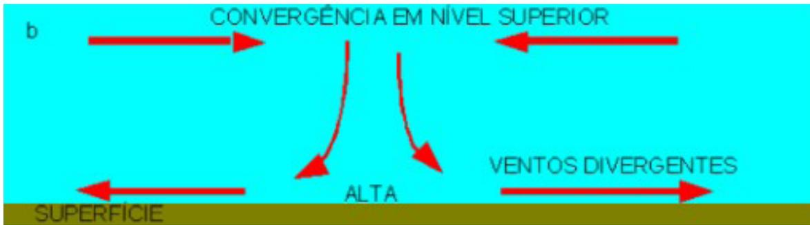
Figura 1. Esquema das correntes de ar associadas a um ciclone / Fonte: Grimm (1999).
