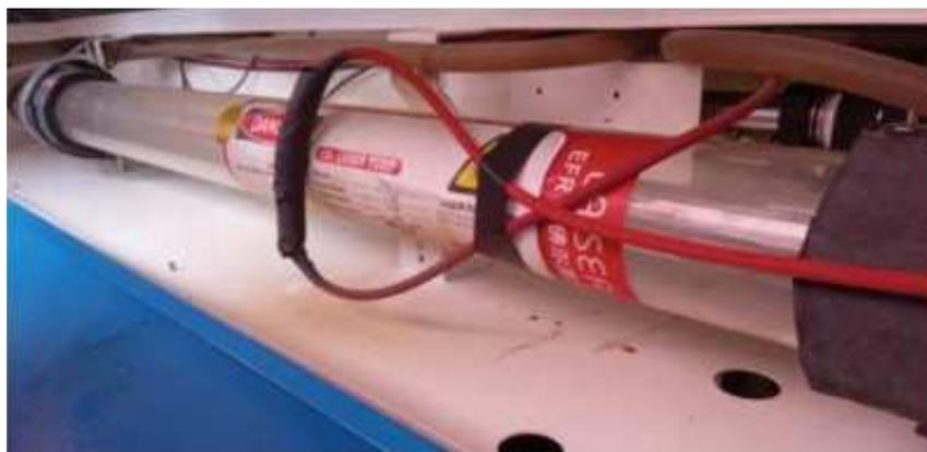
Figura 8. Tubo laser / Fonte: os autores (2023).
