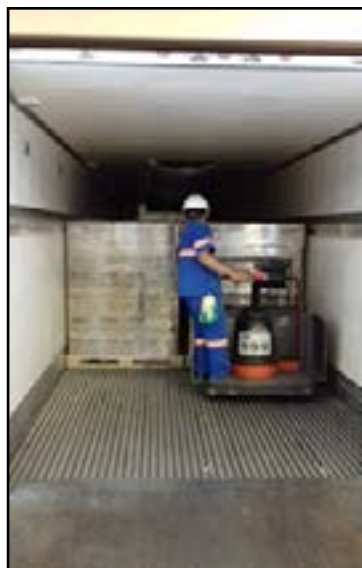
Figura 2. Processo de descarga de veículo
