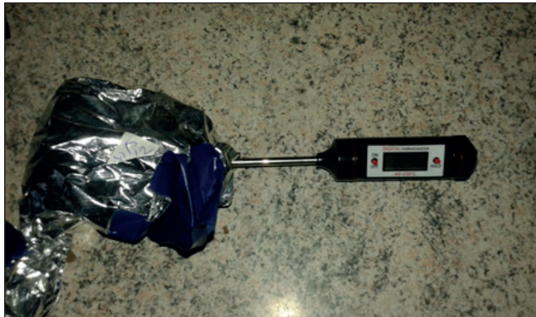
Figura 7. Sistema de medição de temperatura utilizado
