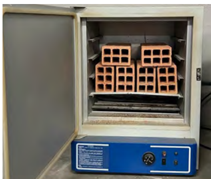
Figura 14. Blocos na estufa por 5 horas
