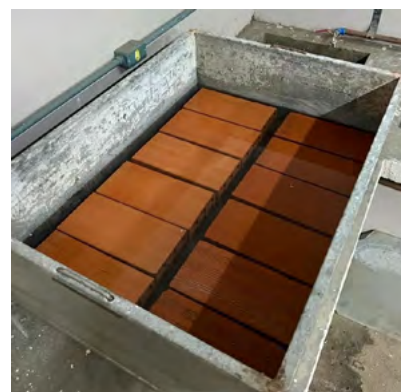
Figura 15. Blocos imersos em água por 24h
