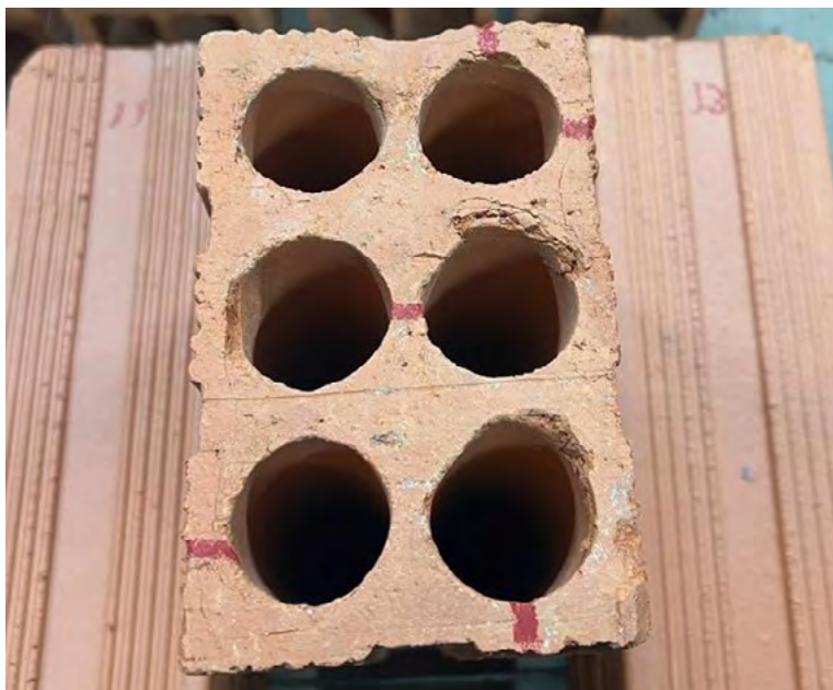
Figura 13. Locais medição das paredes externas e septos
