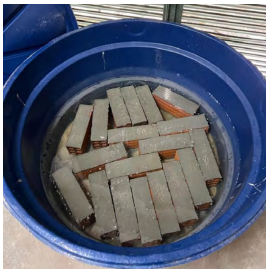
Figura 19. Blocos capeados submersos por seis horas
