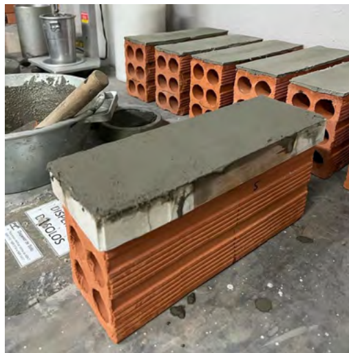
Figura 18. Bloco coberto com argamassa
