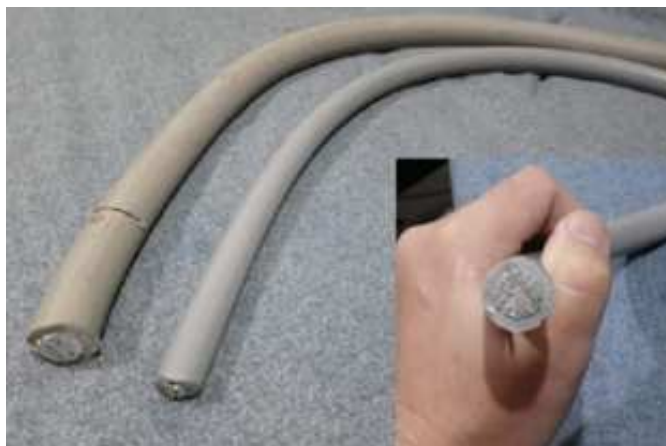
Figura 6 – Cabos da rede compacta, 50\text{mm}^2 (menor), 150\text{mm}^2 (maior) e corte transversal cabo 150\text{mm}^2
