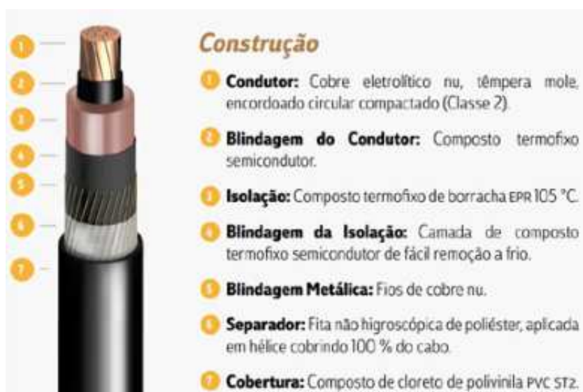
Figura 10 – Representação do cabo subterrâneo e legendas
