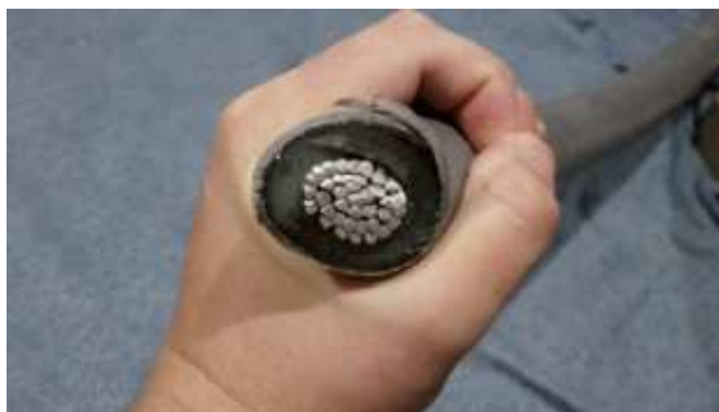
Figura 9 – Corte transversal do cabo multiplexado utilizado
