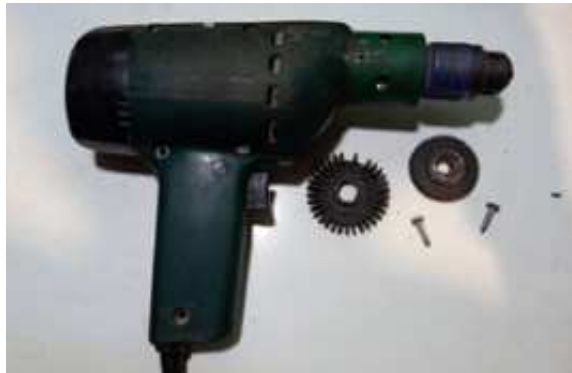
Figura 5 – Furadeira utilizada com ventoinha quebrada
