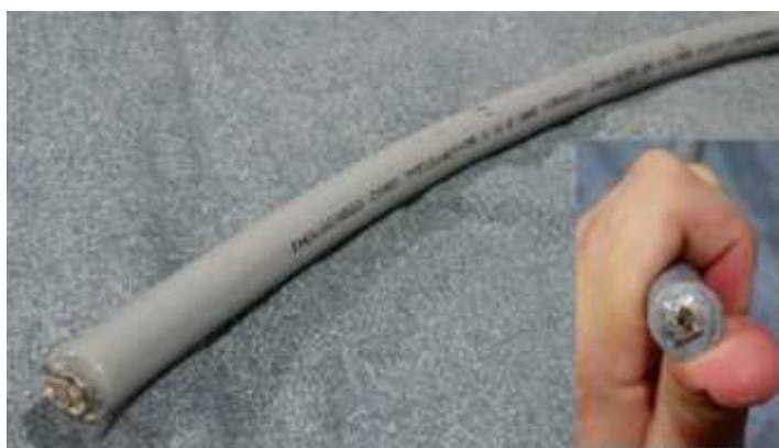
Figura 7 – Cabo autossustentado coberto 35mm 2
