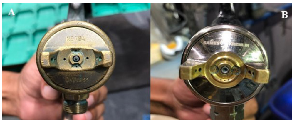
Figura 12. Comparativo de capa de ar na pulverização JGA-503 (A) versus F-Pro Convencional (B).
