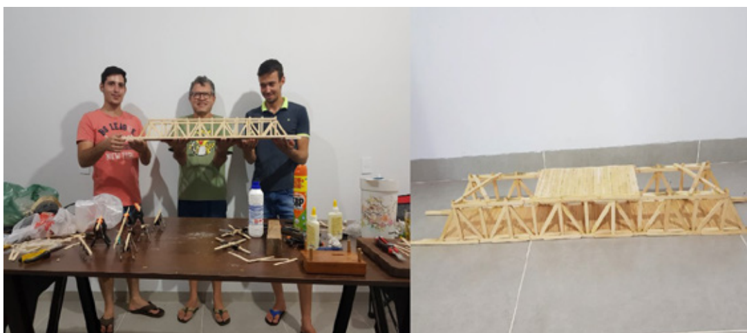
Figura 6. Estrutura completa da ponte treliçada de palito de picolé.
