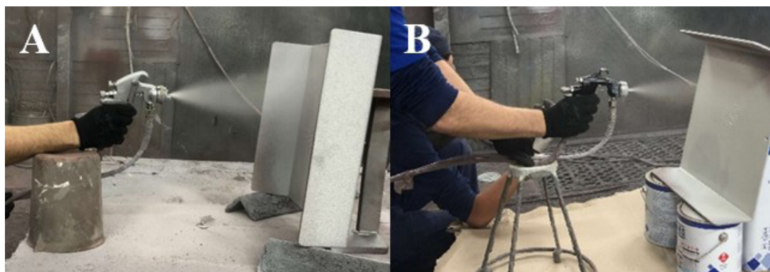
Figura 16. Teste em corpo de prova JGA-503 (A) versus F-Pro Convencional (B).
