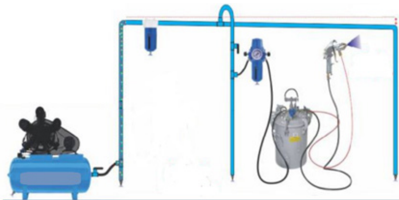
Figura 5. Sistemas de pintura com tanque de pressão.
