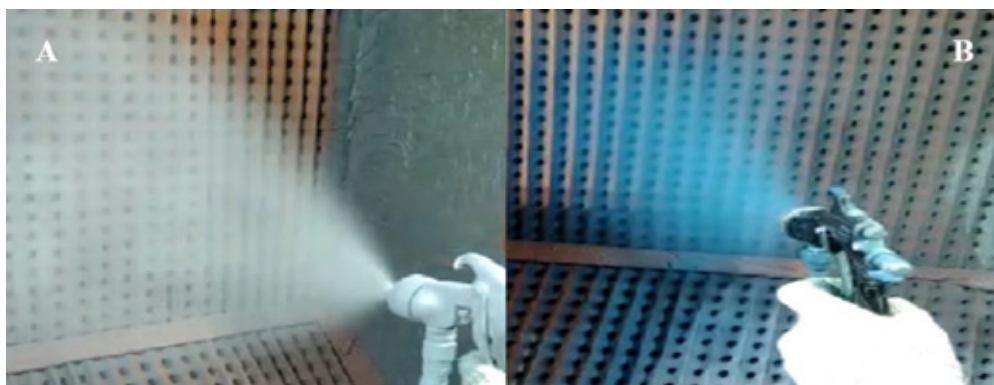
Figura 11. Comparativo de nevoa JGA-503 (A) versus F-Pro convencional (B).
