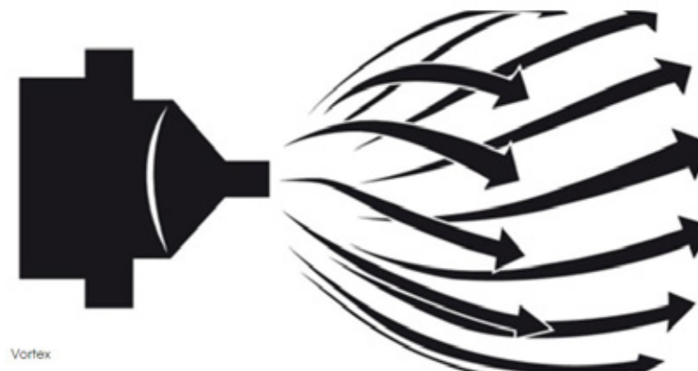
Figura 8. Pulverização de água sem ar com forma helicoidal
