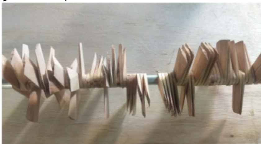
Figura 5. Montagem da rosca transportadora.
