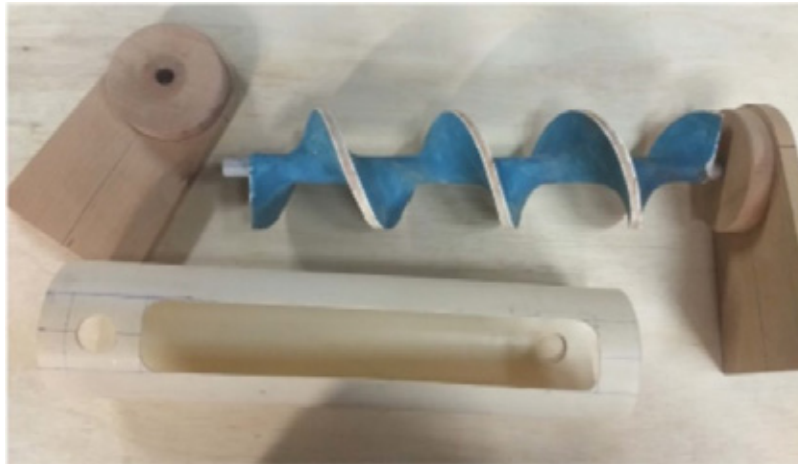
Figura 6. Tampas de fechamento da carcaça e tubo de PVC.
