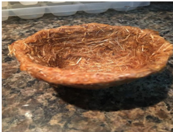
Figura 5. Embalagem produzida a partir do composto da fibra da bainha da palmeira, glicerina, pectina e amido.
