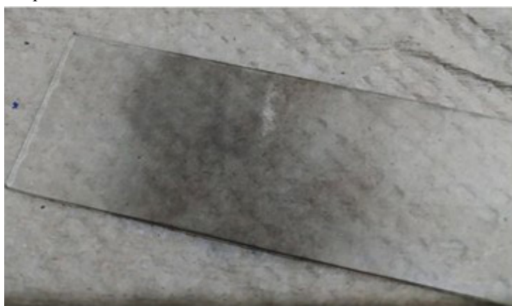
Figura 1. Filme de NiO após o teste de aderência.
