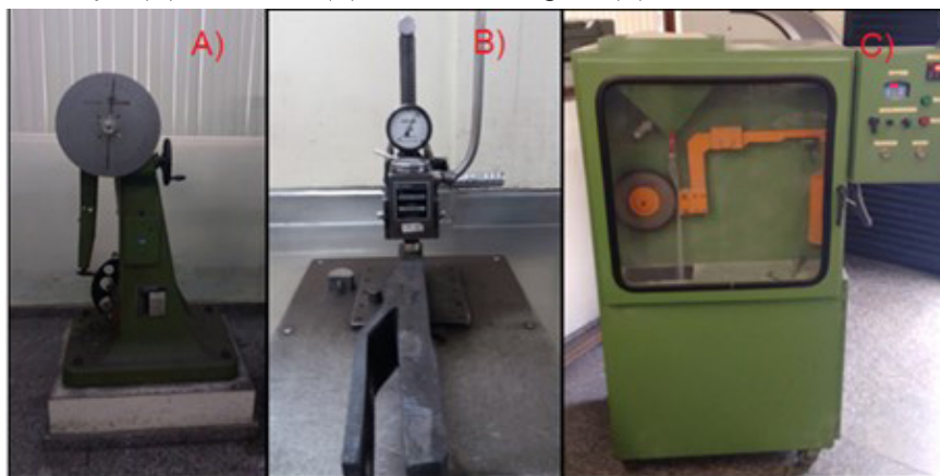
Figura 5. Ensaio de tração (A), durômetro (B) e ensaio de desgaste (C).
