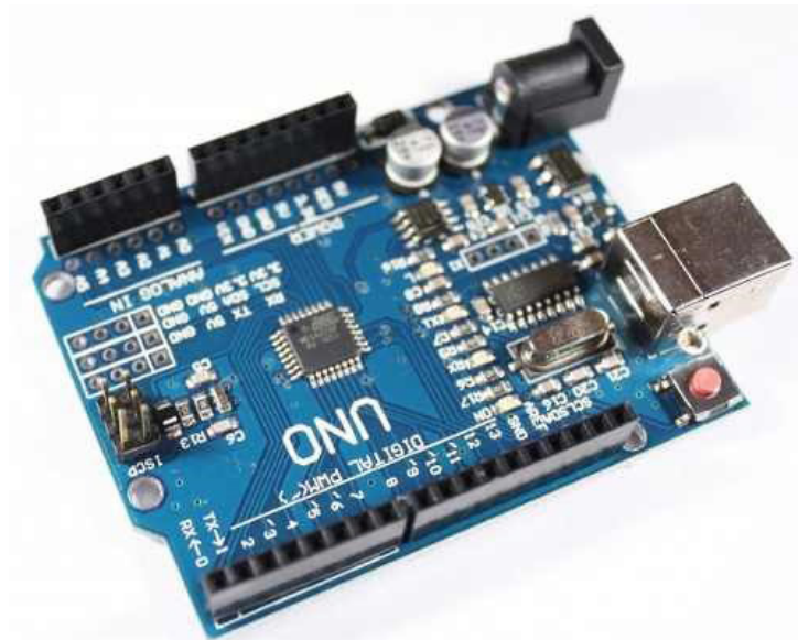
Figura 5. Placa de Arduino UNO R3
