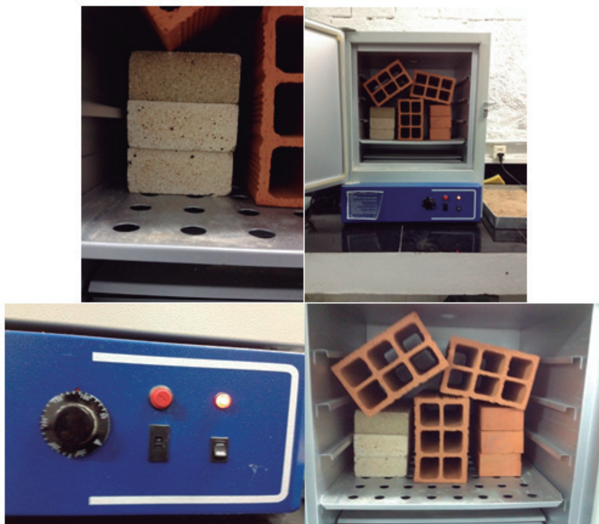
Figura 4. Colocação de tijolos em estufa
