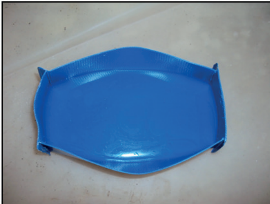
Figura 3. Miniecotêiner com soda cáustica em seu interior, testes de resistência a agentes agressivos
