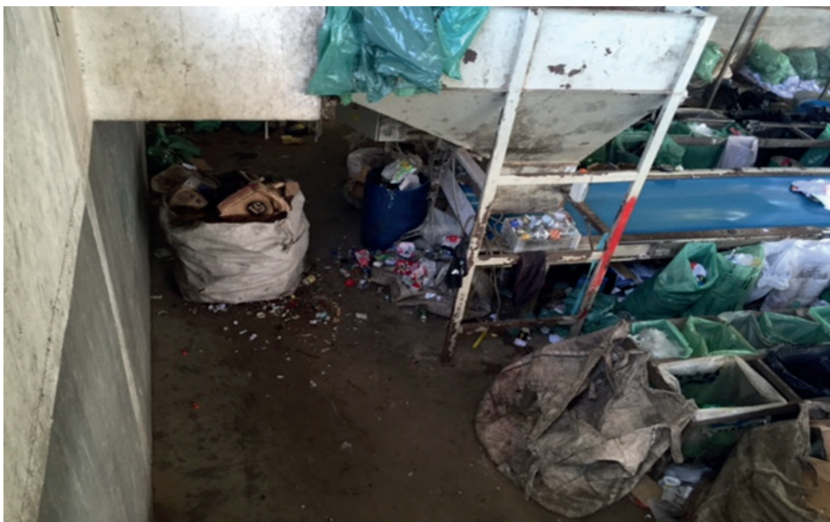
Figura 8. Materiais depositados abaixo da calha sem uso, dificultando sua triagem e gerando desorganização no local de trabalho
