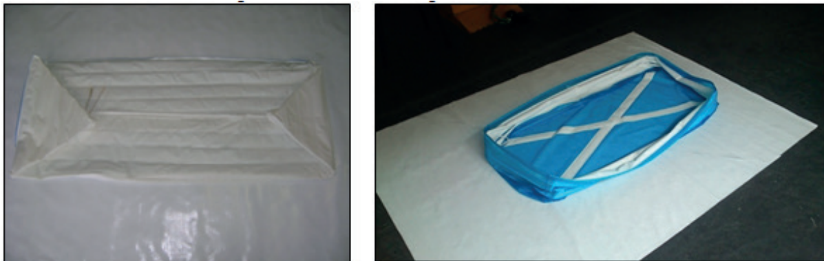
Figura 5. Teste das soldas eletromagnéticas e testes de dobragem do laminado de PVC 0,2 milímetro
