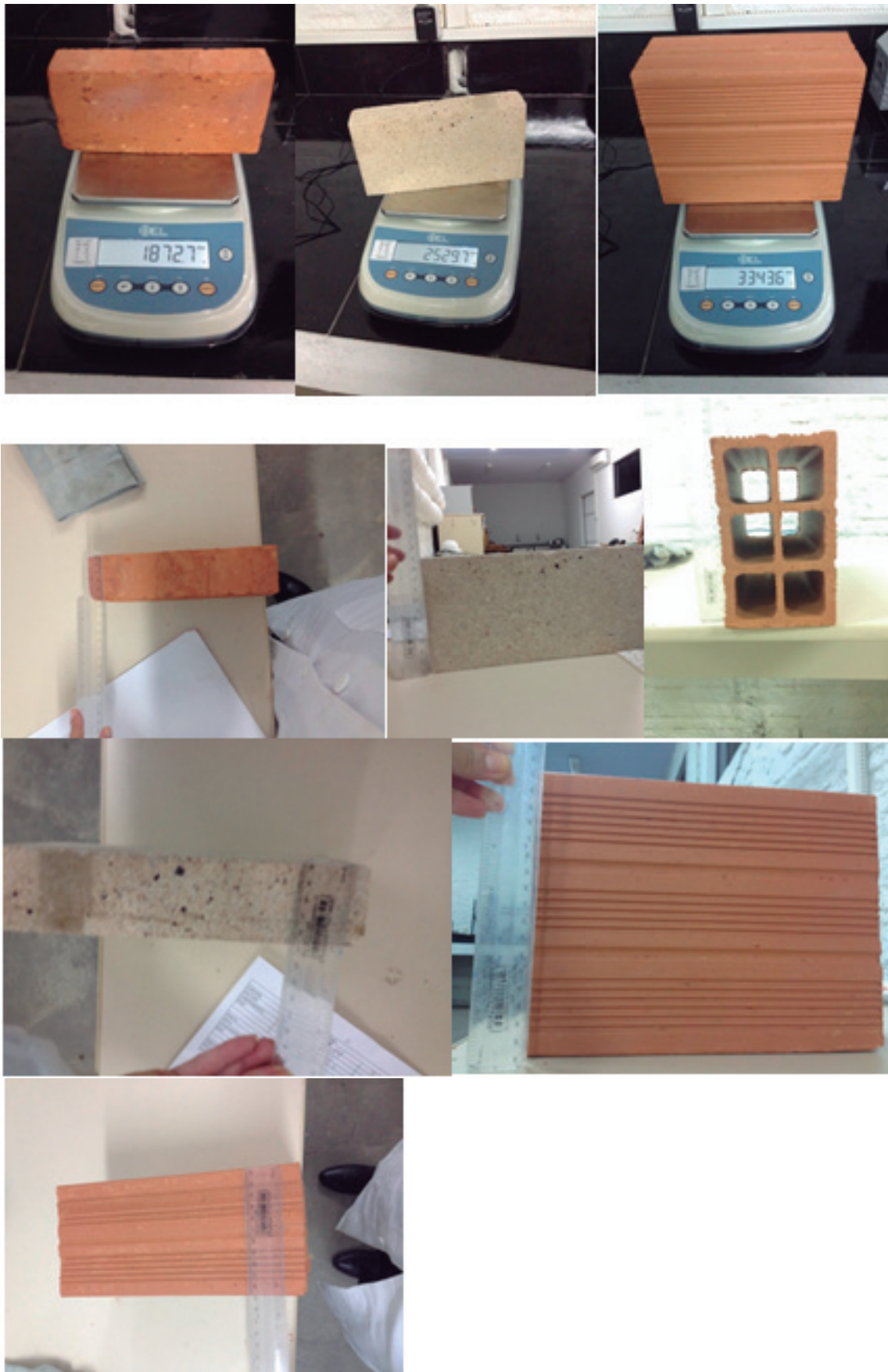
Figura 5. Ensaio tijolo seco
